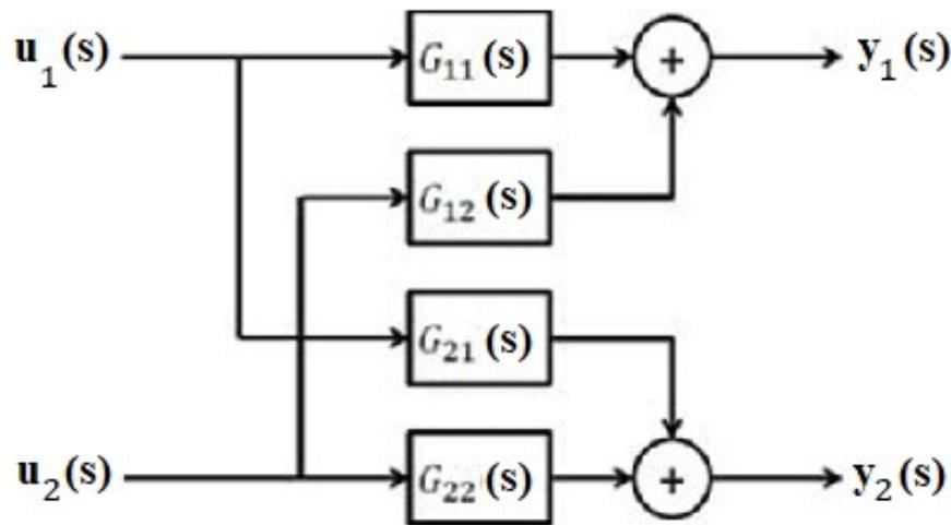
$$\mathbf{G}(s) = \begin{matrix} & \begin{matrix} u_1 & u_2 \end{matrix} \\ \begin{matrix} y_1 \\ y_2 \end{matrix} & \begin{bmatrix} G_{11}(s) & G_{12}(s) \\ G_{21}(s) & G_{22}(s) \end{bmatrix} \end{matrix}$$
