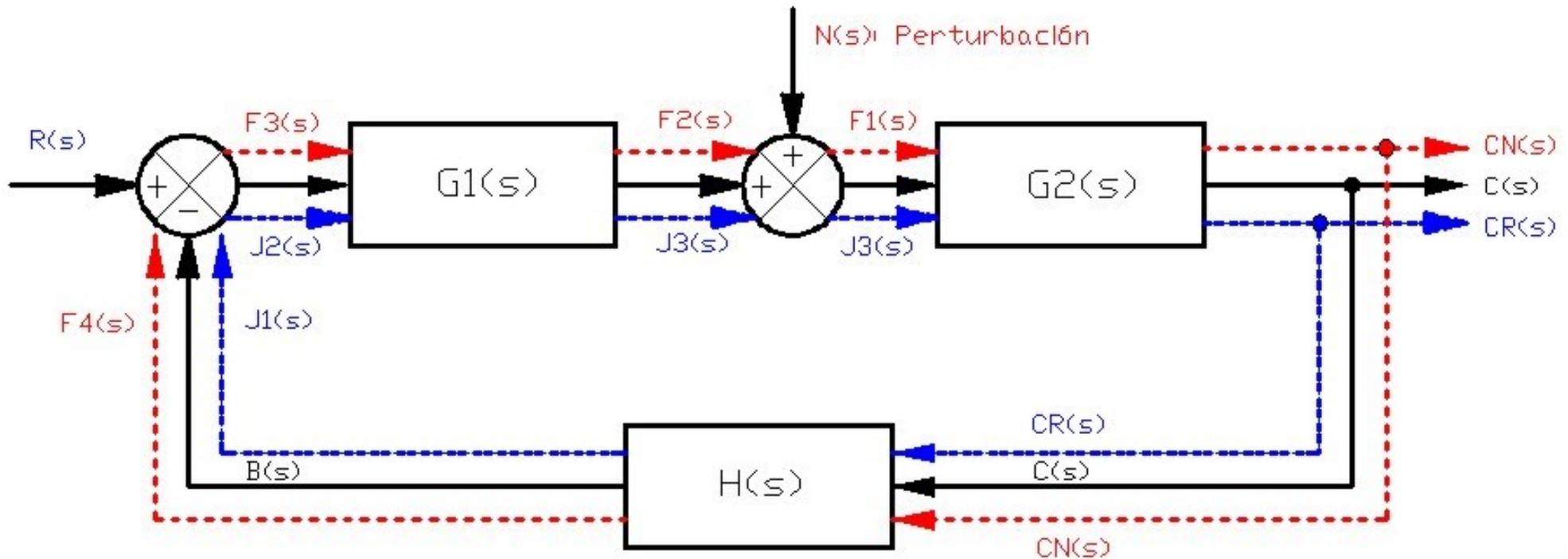
Sistema lineal de dos entradas: 1-  $R(s)$ : Señal de entrada o referencia, 2-  $N(s)$ : Perturbación.
