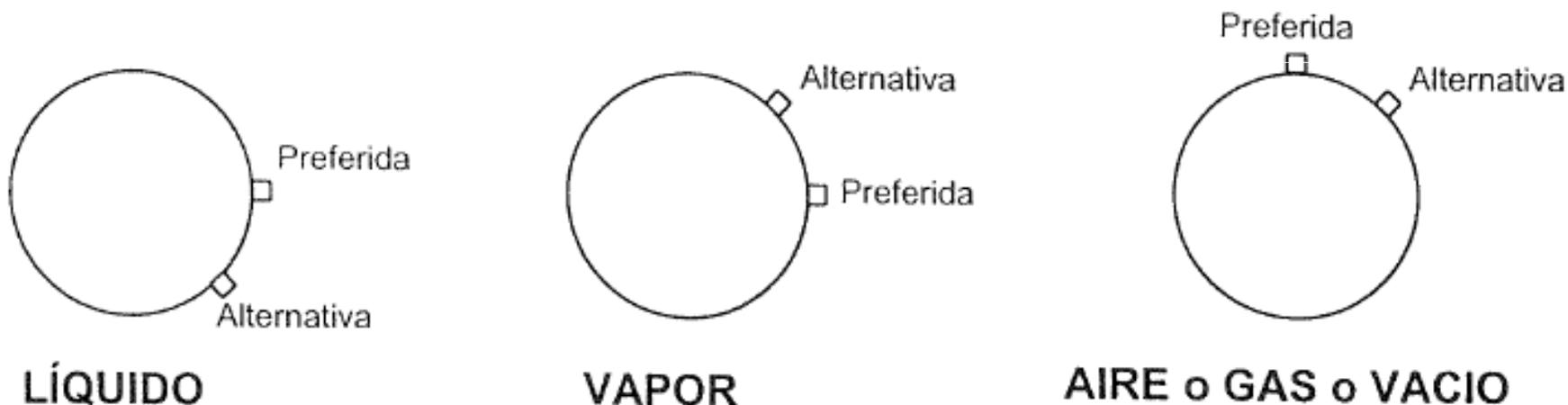
**FLUIDO LIQUIDO – VAPOR:** EVITAR ACUMULACION DE BURBUJAS DE GAS EN TUBING. LOS INSTRUMENTOS DEBEN INSTALARSE POR DEBAJO DE LAS TOMAS DE PROCESO (TUBING CON PENDIENTE DESCENDIENTE).
