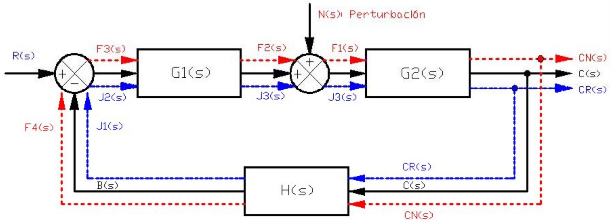
Sistema lineal de dos entradas: 1-  $R(s)$ : Señal de entrada o referencia, 2-  $N(s)$ : Perturbación.
