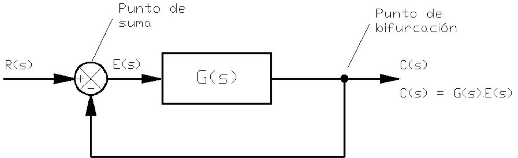
Cualquier sistema de control puede ser representado por un diagrama de bloques consistente en bloques, puntos de suma y puntos de bifurcación.
