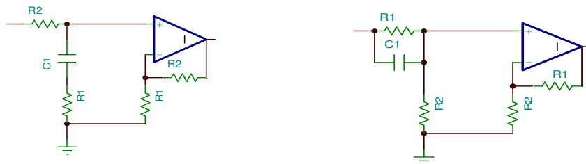
Figura 2: Compensadores de retraso y compensador de adelanto de fase
