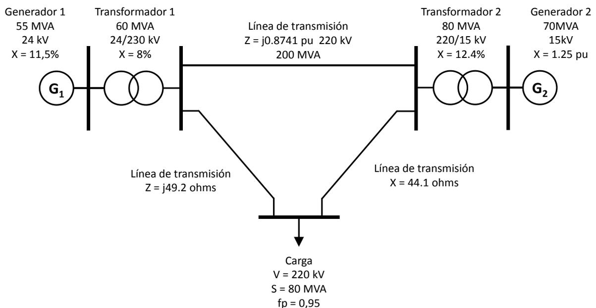
Considerando que la fem interna de los generador es 10% mayor a la tensión en bornes y que se encuentran en fase, determinar las corrientes y tensiones del circuito en valores absolutos.
