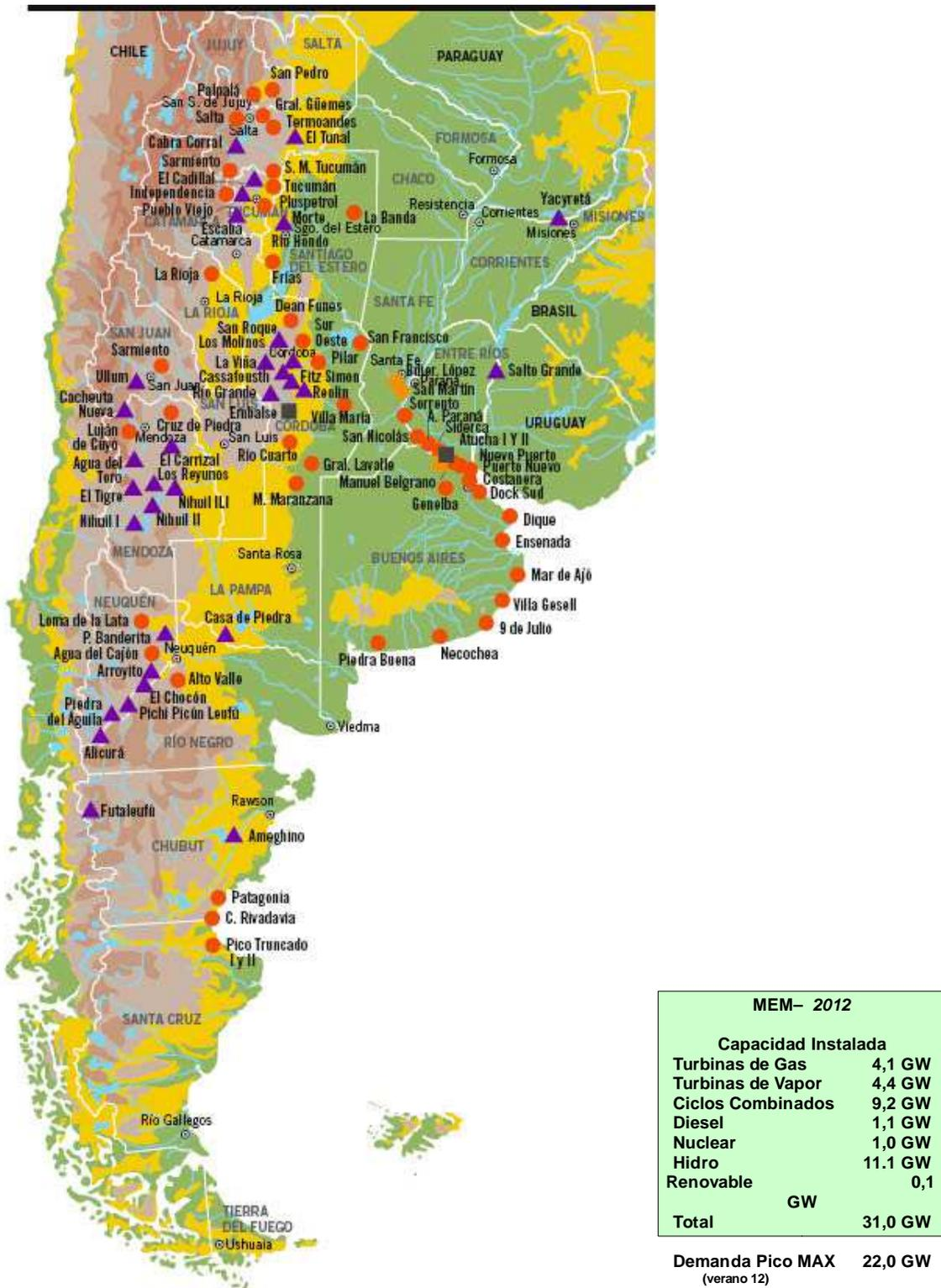
Fig. 9.-Ubicación de distintos tipos de Centrales (hidro, térmicas, nucleares)
