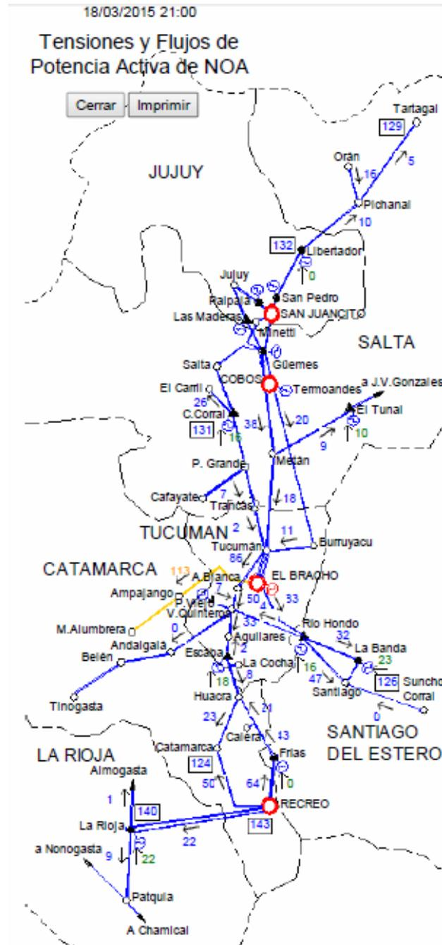
Fig. 17.- Flujos de carga por líneas de 132 kV del NOA, el 18/03/2015 a las 21:00 hs
