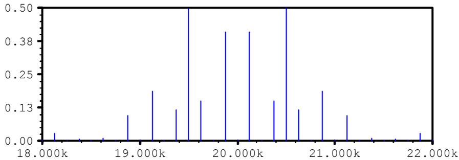
El ancho de banda resultante (componentes significativas) es, aproximadamente, 2kHz. En éste caso  $\Delta f = 0.5 \text{ kHz} = R_b/2$ , es decir que la diferencia entre las frecuencias de 1 y 0 lógicos es  $R_b$  Hz., en la literatura se lo conoce como FFSK (Fast FSK). Otro caso de utilización extensa es MSK (Minimum Shift Keying), donde  $\Delta f = R_b/4$ . En el ejemplo tendría que ser  $\Delta f = 0.25 \text{ kHz}$  y el espectro resultante es:
