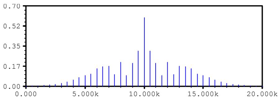
b) Señal de PM, frecuencia de portadora  $f_0 = 10 \text{ kHz}$  y  $\Delta\phi = 2.5 \text{ rad}$ . Ancho de banda pronosticado:  $2.2 \cdot (2.5 + 1) = 14 \text{ kHz}$ , igual que antes, se espera que el espectro de la señal modulada abarque de  $10 - 7 = 3 \text{ kHz}$  a  $10 + 7 = 17 \text{ kHz}$ . Espectro:
