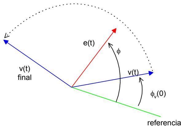
Se ve del diagrama que, como  $s(t)$  es  $> 0$ , la frecuencia instantánea de  $v(t)$  aumenta y su fasor representativo gira en el sentido de las agujas del reloj (más rápido) hasta llegar a una posición de equilibrio estable cuando  $\phi - \phi_v(t) = -\pi/2$ , que hace  $s(t) = 0$ .
