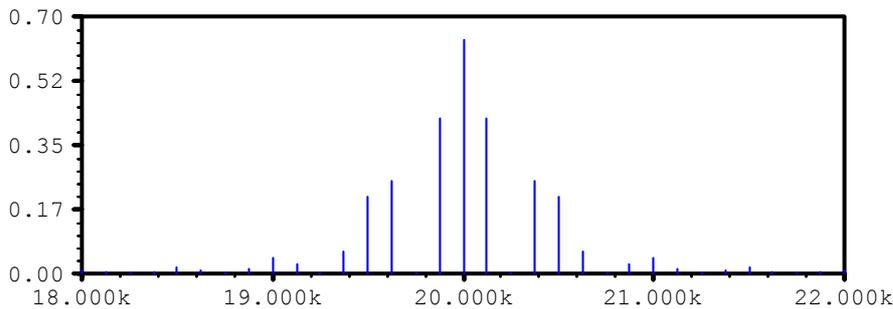
Notar la reducción del ancho de banda ocupado. Si, previo a la modulación, se filtra la señal  $x(t)$  con un filtro Gaussiano se tiene un sistema GMSK (Gaussian MSK), que es el mas común de los métodos empleados en NFSK.
