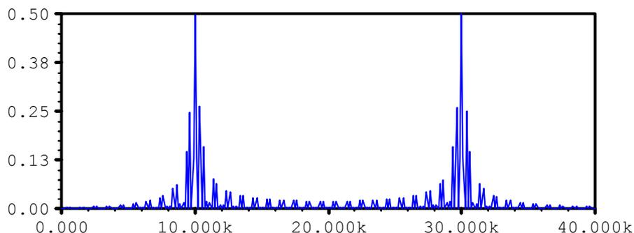
El ancho de banda ocupado tiende a  $2 \cdot \Delta f$ . Si  $\Delta f$  está en el orden de  $R_b$  se tiene un sistema FSK de banda angosta (NFSK). En el caso anterior si  $\Delta f$  se reduce a  $0.5 \text{ kHz}$ , el espectro resultante es:
