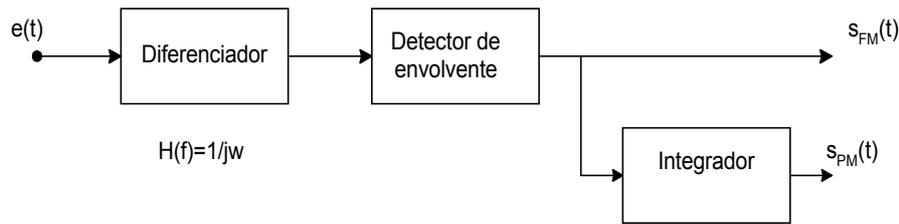
Si la entrada es:  $e(t) = A \cdot \cos(\omega_0 t + \phi(t))$ , a la salida del diferenciador se tiene:
