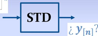
Toda señal de entrada puede descomponerse en infinitas señales elementales (que tengan un solo valor distinto de cero para  $n=m$ ) pudiéndose del mismo modo, para un sistema lineal e invariante en el tiempo, determinar la señal de salida como la sumatoria de las señales de salida correspondiente a cada una de las señales elementales.
