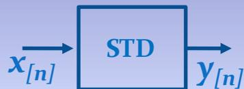
En la asignatura se trabajará con sistemas de tiempo discreto en los que la salida  $y[n]$  es una combinación lineal del valor actual y pasados de la señal de entrada  $x[n]$  y de valores pasados de la señal de salida.
