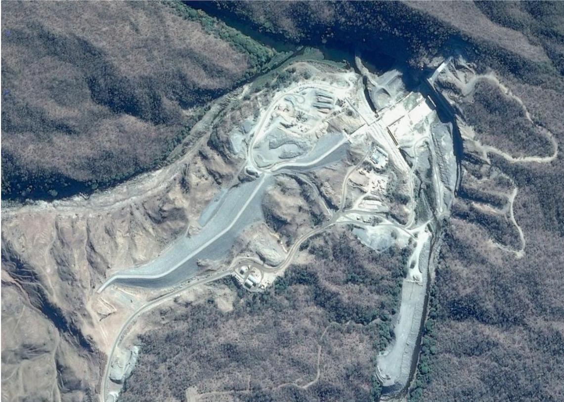
Fotografía N°2. Presa el Bolsón. Cierre Principal de HCR y cierre lateral de materiales sueltos.
