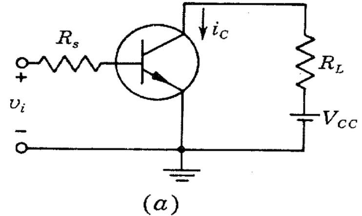
**OFF::**  $I_B = 0 \Rightarrow I_L = I_{CB0} \approx \mu A \Rightarrow$  Junturas Inversas
