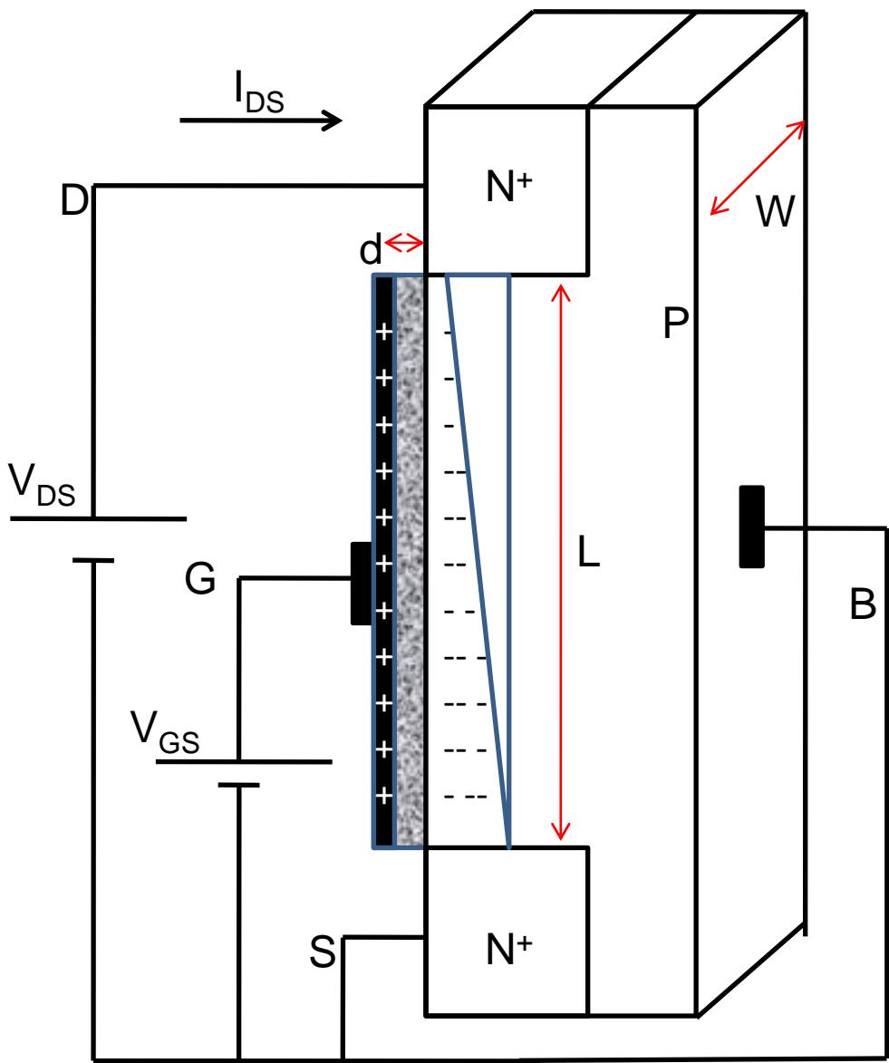
$$I_{DS} = \frac{\text{Carga móvil en el canal}}{\text{Tiempo de Transito}}$$
