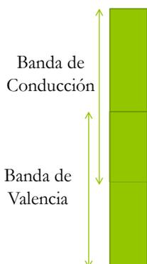
Con la influencia de un campo eléctrico los electrones pueden adquirir una energía adicional y cambiar a etapas más elevadas. Ya que estos electrones móviles constituyen una corriente, estos materiales son conductores y la región parcialmente llena es la banda de conducción.
