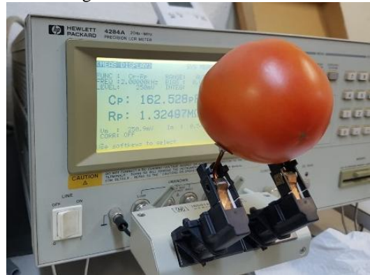
Figura 4: Adaptación de la celda de Varlan- Sansen.
