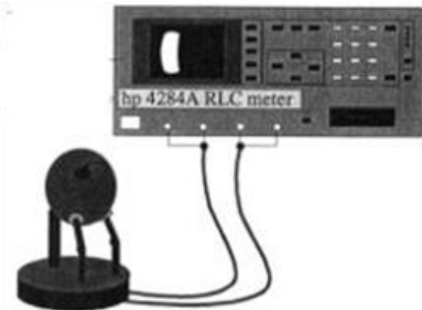
Figura 2: Celda de Varlan- Sansen conectada al analizador de impedancia.
