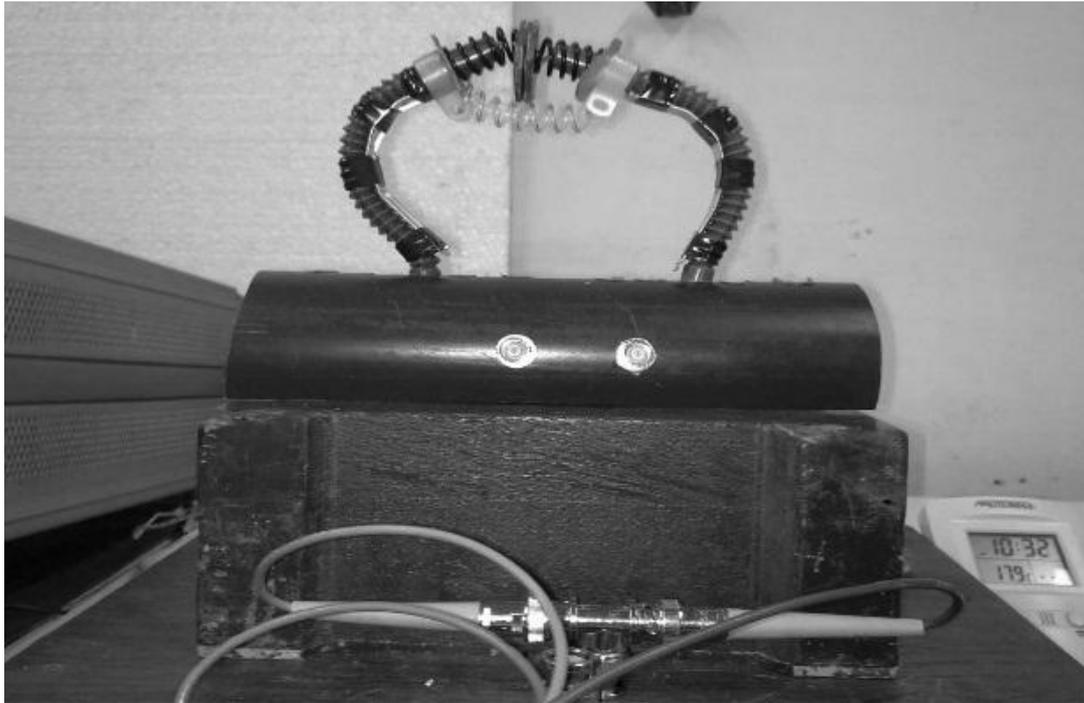
Figura 4: Celda flexible con electrodos adaptable
