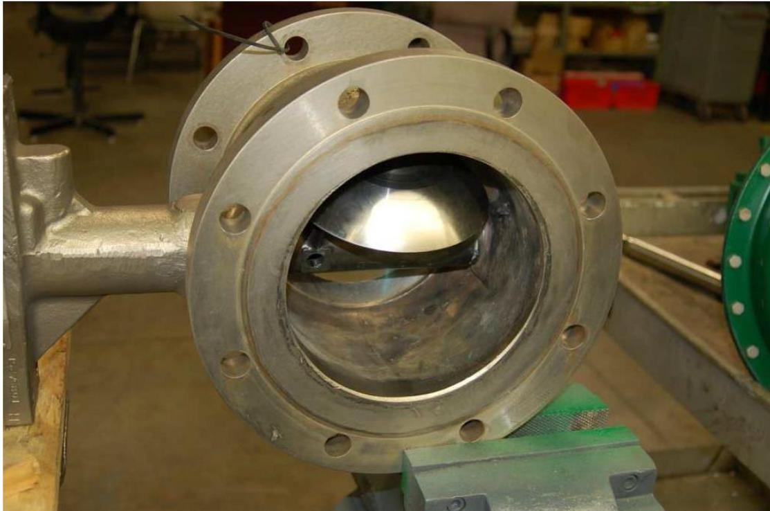
Consiste en un **obturador de superficie esférica** que tiene un movimiento excéntrico rotativo. El **torque necesario** para el movimiento relativamente **moderado**.
