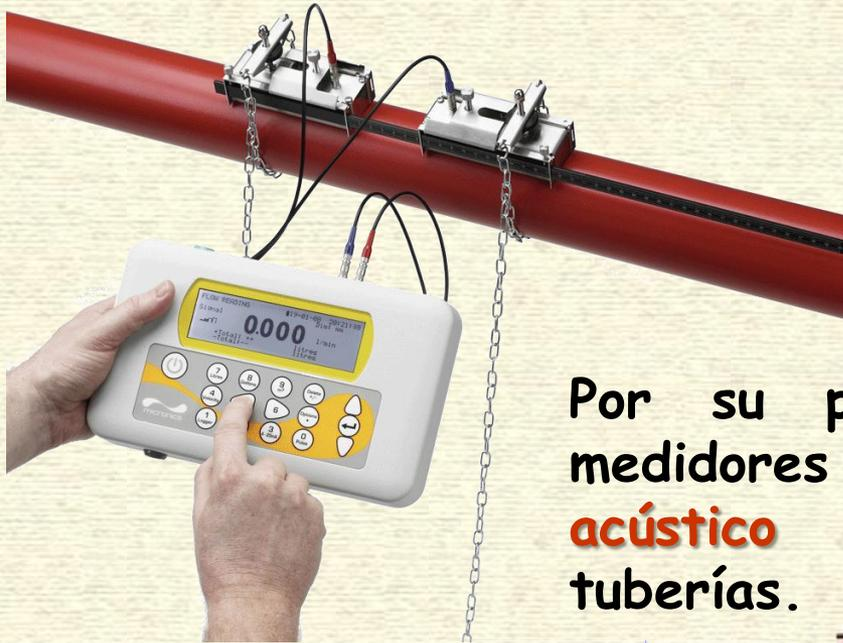
Por su principio de operación, estos medidores pueden ser afectados por **ruido acústico** generados por válvulas o tuberías.
