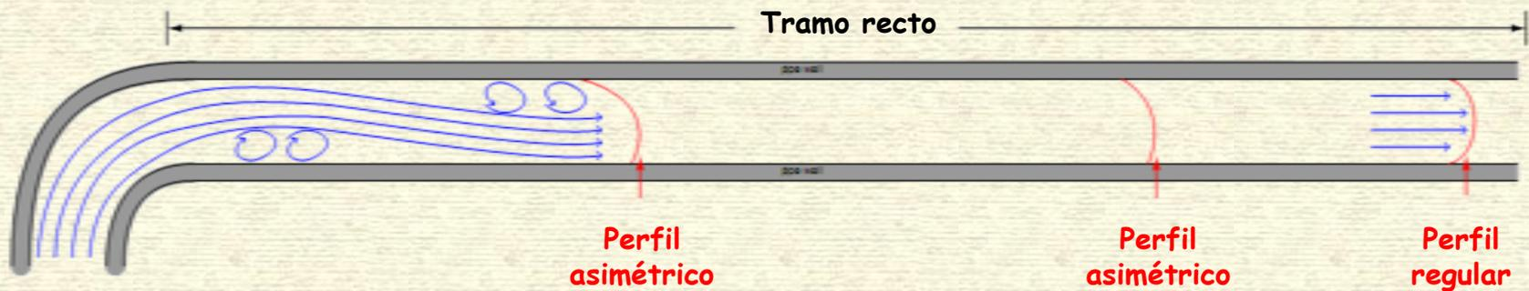
Con enderezadores de vena fluida se puede disminuir el tramo de cañería recta que se requiere antes de el medidor.
