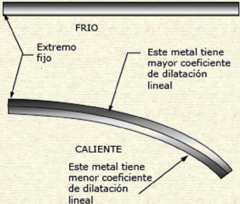
Este termómetro consiste en una cinta hecha de **dos metales (o aleaciones) de coeficientes de dilatación térmica muy diferente**, tales como el Invar y el latón, soldados cara con cara en toda su longitud.
