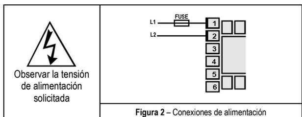
Figura 2 - Conexiones de alimentación
