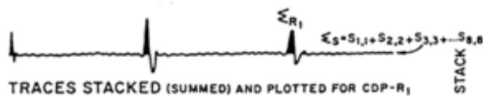
El pulso, único por cada reflexión, se representa bajo el correspondiente geófono a una profundidad equivalente en la escala de tiempos. Existen dos formas de presentación del pulso:
