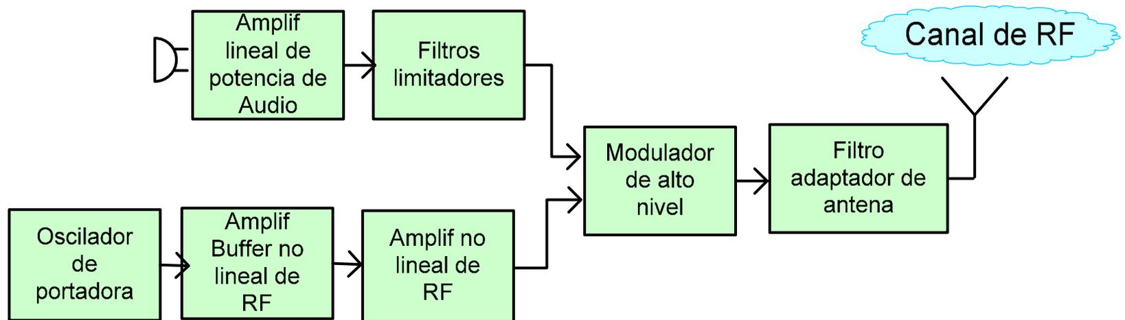
En los transmisores de alto nivel, el circuito del modulador tiene tres funciones principales: es el modulador (es decir, no lineal), es el amplificador de potencia final (clase C) y es un convertidor ascendente de frecuencia.
