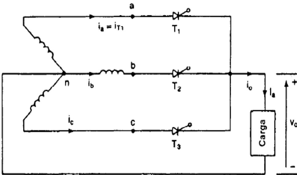
b) 1) Circuito **RECTIFICADOR TRIFASICO DE ONDA COMPLETA**
