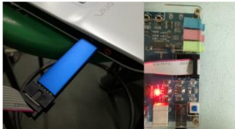
Figura 10: Conexión del cable USB Blaster en la FPGA y la computadora
