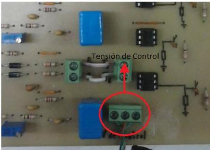
Esta bornera es la de la tensión de control, con la cual se maneja el ángulo de disparo de los tiristores. El borne de la izquierda es la masa (GND) de la alimentación, y el borne derecho es +12 V. El borne central es el de referencia o control. En la plaqueta se encuentra pegado un Trimpot, conectado a esta bornera, para realizar el control del ángulo.
