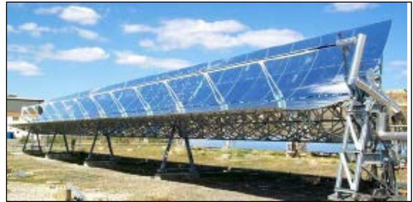
**Concentrador Cilindro Parabólico**
