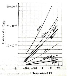
de  $\rho = \rho(T) \approx \rho_0 [1 + \alpha_0 (T - T_0)]$  y escriba la dependencia de la resistencia con la temperatura.
