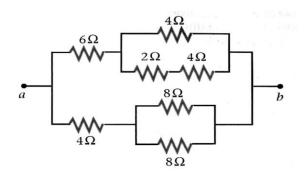
**Ejercicio 13** En el circuito de la figura a) calcule la resistencia equivalente b) si se conecta una fuente de 12V entre a y b ¿cuál es el valor de la corriente que circula en cada resistencia? c) ¿qué potencia debe entregar la fuente?
