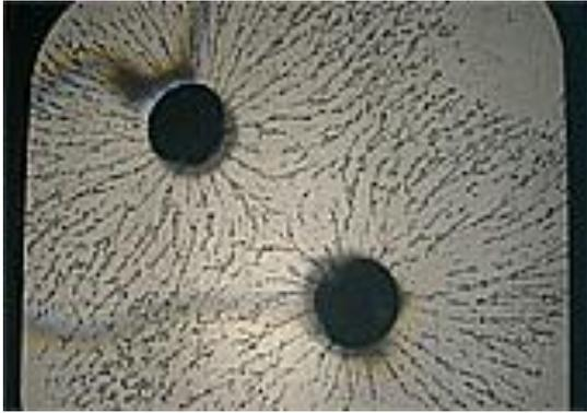
1 - La imagen representa las hojas de té ordenadas sobre una placa de vidrio en donde los círculos son dos los contactos metálicos que se conectan a potenciales. Indique a) el signo de las cargas que adquieren los círculos, b) la diferencia de potencial entre los círculos ¿es nula, mayor que cero o menor que cero? Justifique
