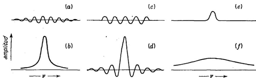
**Ejercicio 1** Analice las gráficas donde a, c y e son perfiles de ondas "finitas", b, d y f son sus espectros de frecuencia Agregue en la secuencia, la luz monocromática
