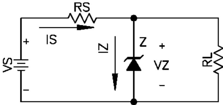
$$R_S < \frac{V_{S\text{MIN}} - V_Z}{I_{L\text{MAX}} + I_{Z\text{MIN}}}$$
