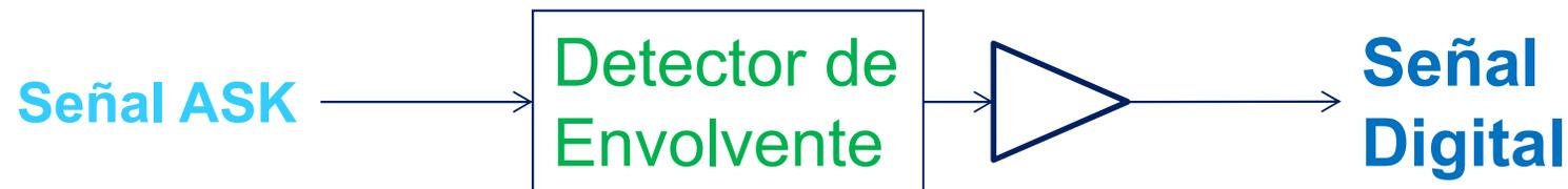
Se detecta la presencia de una señal portadora de amplitud mayor a un determinado umbral, lo cual se puede realizar con un detector de envolverte, luego se amplifica la señal detectada para obtener el nivel adecuado.
