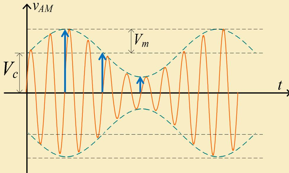
El fasor resultante de la suma de los fasores  $v_{BLS} + v_{BLI}$  tiene la misma dirección que el fasor  $v_c$
