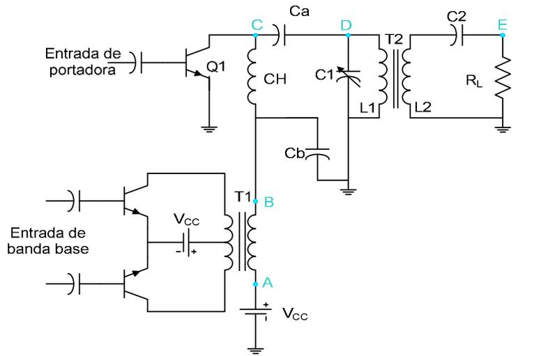
\*CH: choke de RF. Esta es una bobina que presenta una reactancia elevada a la señal de RF para que no pase a la fuente ni al circuito del modulador.
