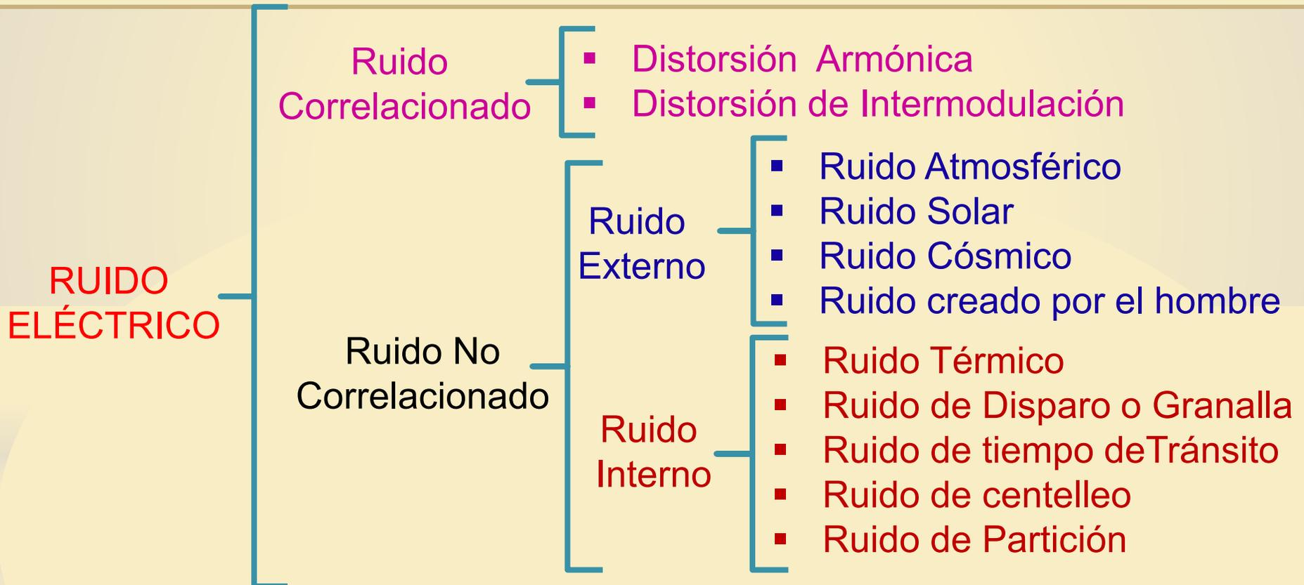
Ruido correlacionado: tiene relación directa con la señal, es producido por amplificaciones no lineales de la señal. Incluye armónicos y distorsión de intermodulación.
