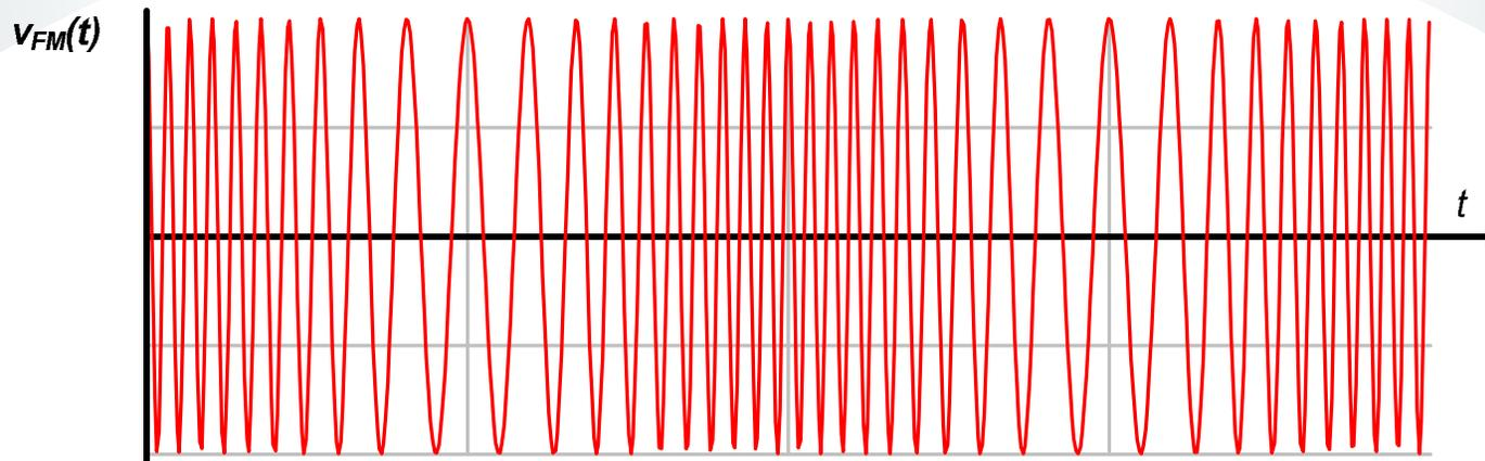
Cuando la portadora varía su frecuencia con la señal de información a transmitir, resulta una señal modulada en frecuencia, cuya expresión está formada por un conjunto de senoidales de distintas frecuencias y amplitudes.
