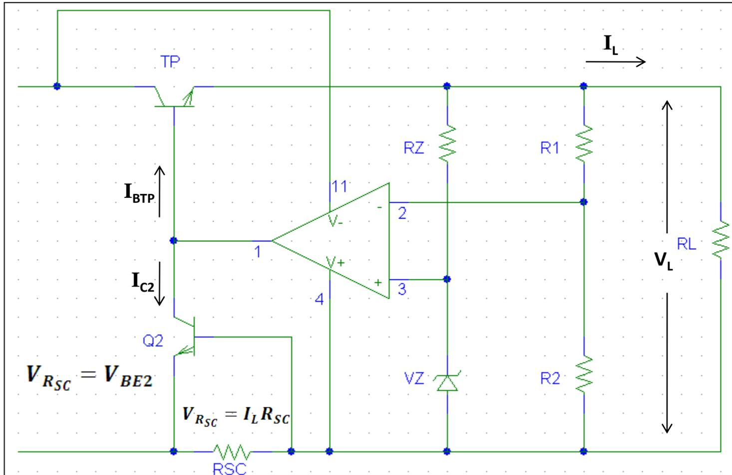
Cuando  $V_{RSC} = V_{BEon}$   $I_{C2}$  le quita corriente a la base de  $T_p$
