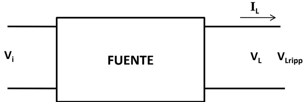
1 – Tensión de salida  $\rightarrow V_{LN} |_{V_i}^{I_L - T_{AMB}}$
