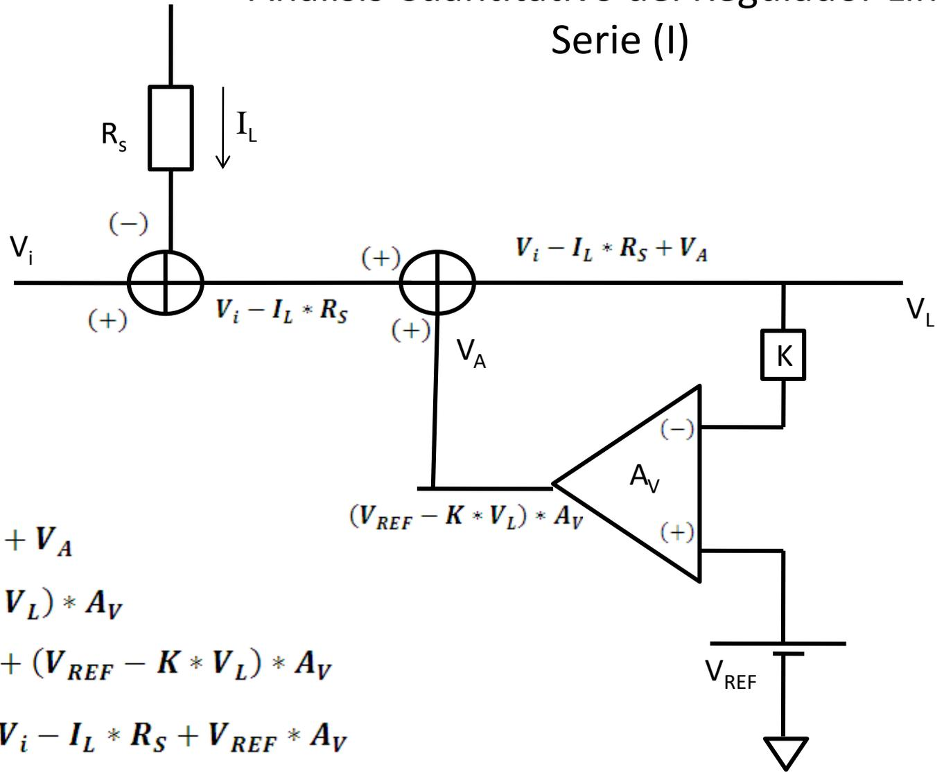
$$V_L = V_i - I_L * R_S + V_A$$
