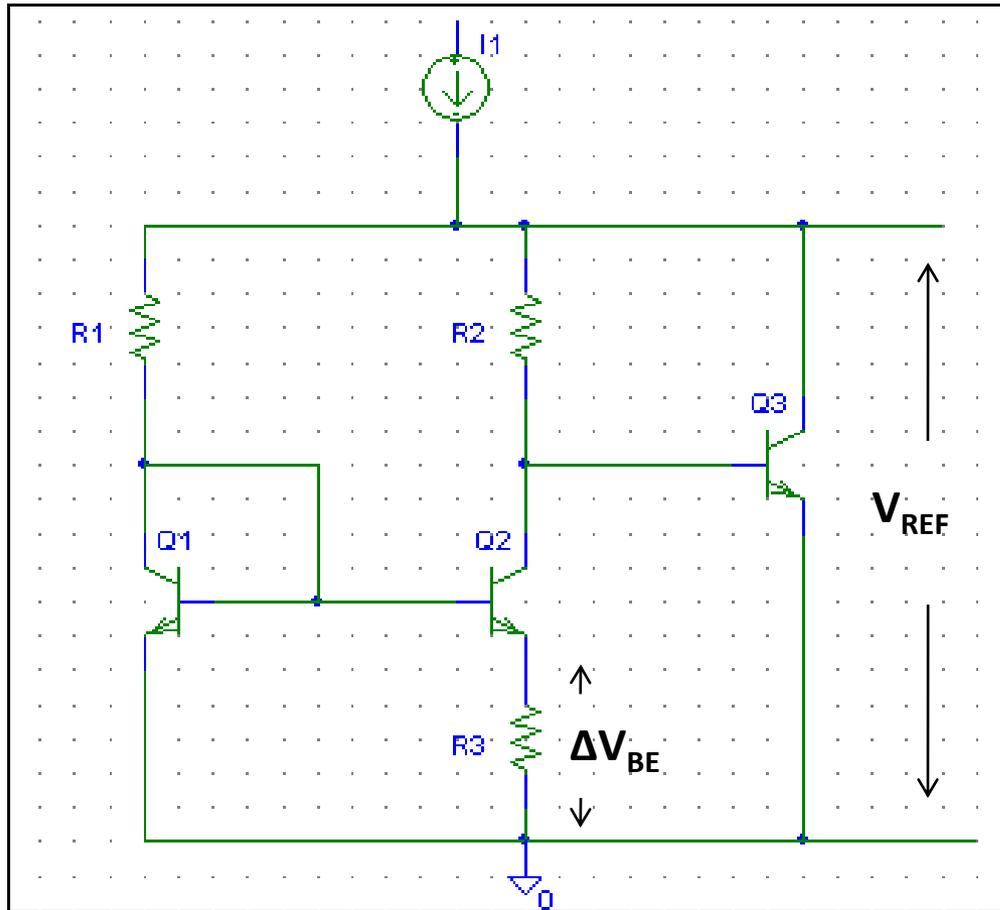
$$V_{REF} = V_{BE3} + V_{R2}$$
