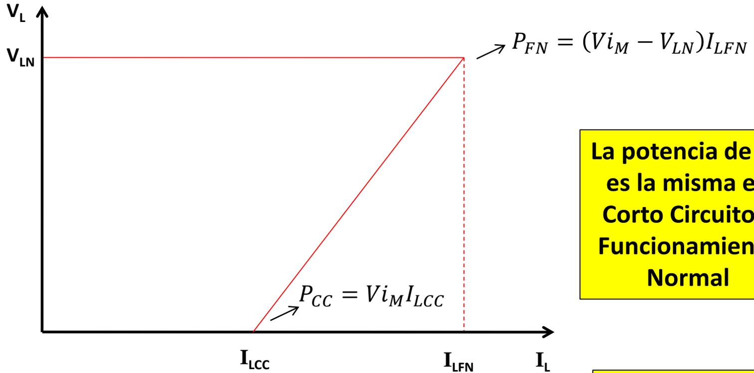
**La potencia de TP es la misma en Corto Circuito y Funcionamiento Normal**
