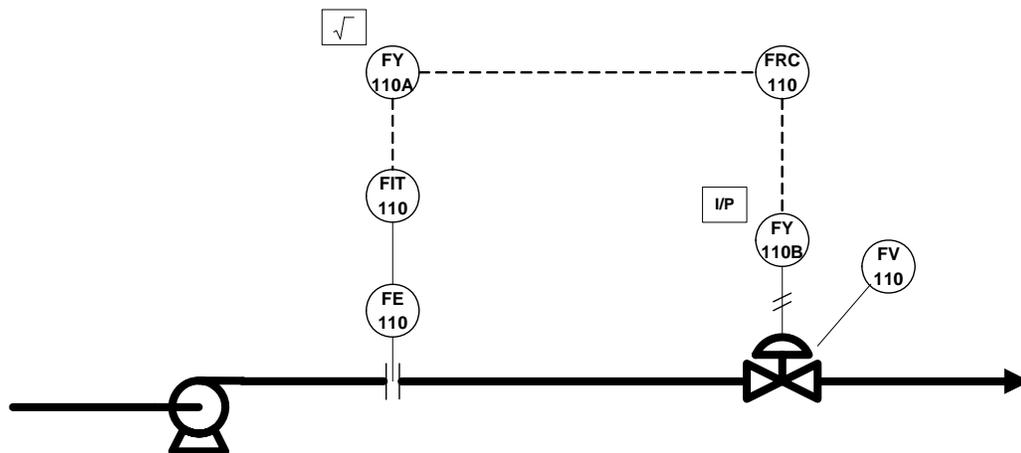
El círculo FE-110 indica el elemento primario de medición de caudal (como se colocaron las dos barras sobre la línea de caudal, se trata de una placa orificio con tomas en bridas) conectado a un transmisor FIT-110 (la letra I significa que existe un indicador local). Este transmisor es electrónico, ya que la señal de salida es una línea de guiones.
