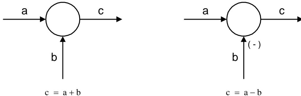
Cuando una de las señales se resta, debe indicarse explícitamente en la proximidad del sumador con el signo '(-)'. Toda la representación de un sistema físico en el que existen diversos subsistemas y en que se relacionan diversas variables se debe describir con estos tres elementos.
