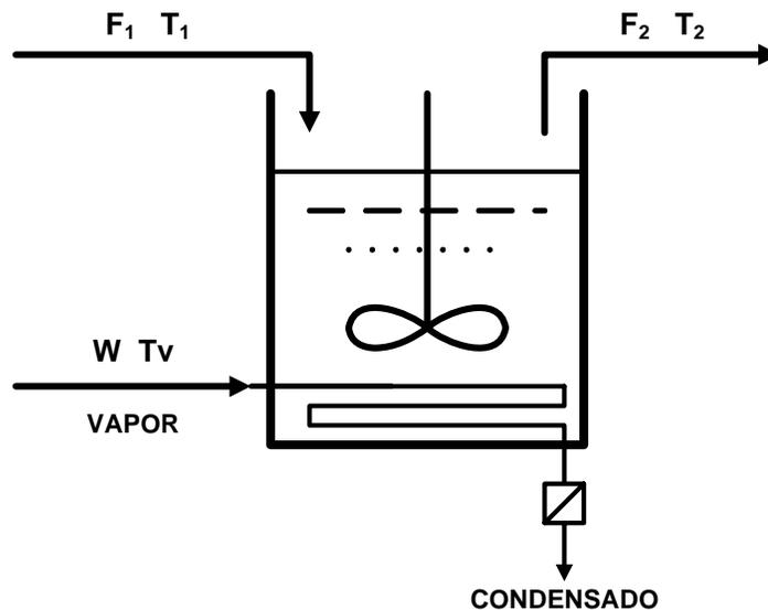
Hay diversas variables de entrada. Considérese  $T_1$  y  $W$  (se supone que solo éstas cambian). Debido al cambio de estas entradas, la temperatura  $T_2$  cambiará. Se observa la acción de dos causas (variables de entrada) y el efecto sobre una variable de salida  $T_2$  a través de un sistema que en este caso es el tanque. Para representar esta relación entrada-salida (causa-efecto) se puede emplear el siguiente *Diagrama en Bloques*:
