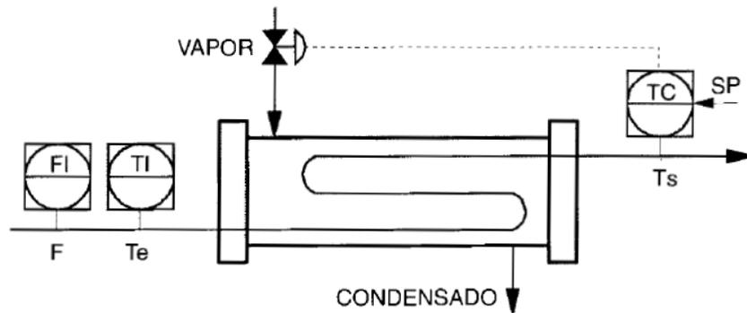
Para poder sintonizar adecuadamente el lazo de control se hicieron ensayos en lazo abierto. Se practicaron escalones de en la señal de salida del controlador ( $u$ ) para las dos condiciones extremas de caudal de alimentación y se registró la salida del transmisor de temperatura.
