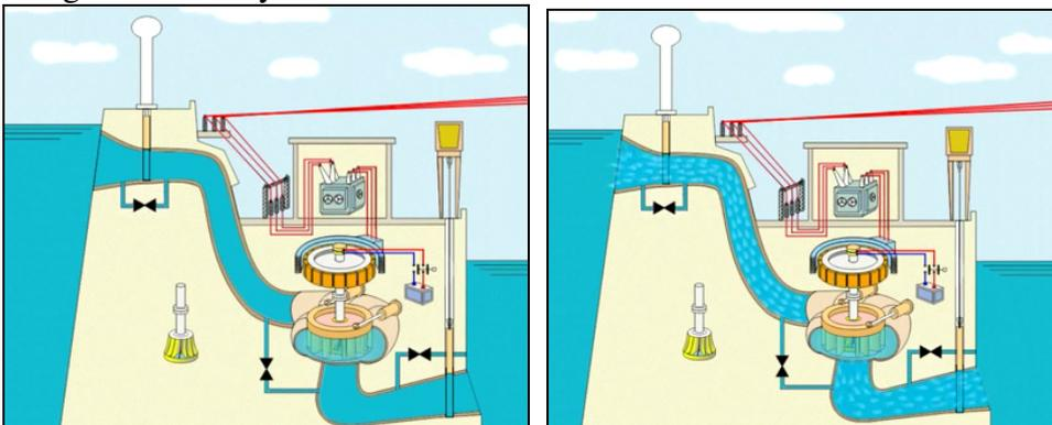
**Nota:** Se deben realizar al mismo tiempo, determinados pasos que tienen que ver con la energización del sistema (excitación del generador, sincronización, etc.)
