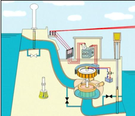
6) Se abre el distribuidor de la Turbina y el agua comienza a circular, produciendo energía mecánica y eléctrica.
