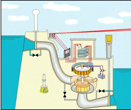
2) Se abre válvula by pass de la parte del tubo de succión (aguas abajo) y se empieza a inundar la tubería de succión, cámara espiral y parte de la tubería de presión. Este proceso continúa hasta que se alcanza el equilibrio hidráulico.
