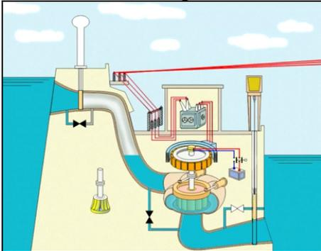
4) Se abre válvula by pass de aguas arriba inundando toda la tubería de presión
