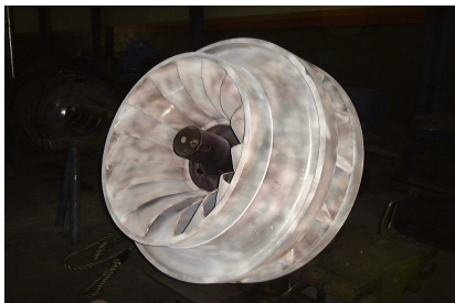
Prueba de fisuras superficiales con tinta penetrante
