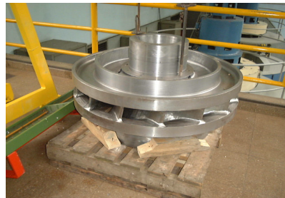
Rodete terminado a pie de maquina listo para montajes
