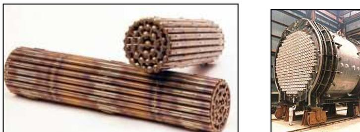
Fig. 13.- Haz de combustible para un reactor tipo CANDU
