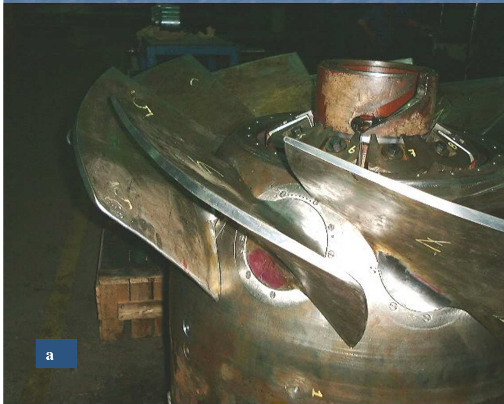
Turbina Deriaz (reacción) de álabes orientables. a – Rodete de turbinada Deriaz, C.H. Cadilla. b – Otro tipo de rodete de turbina Deriaz, para operar la máquina como turbina-bomba.
