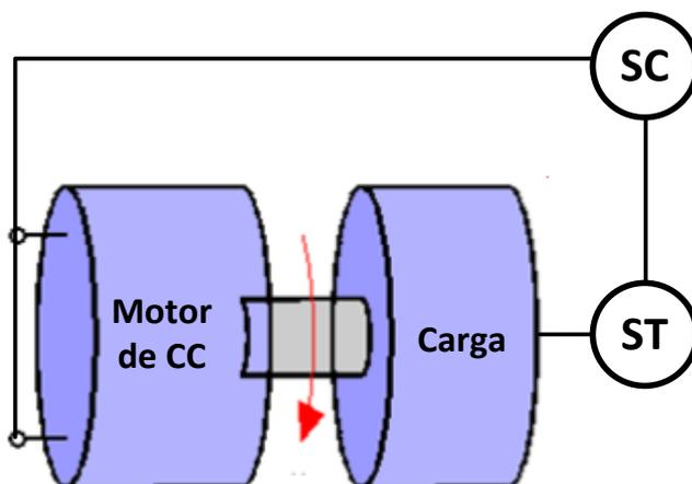
**MÁQUINA HERRAMIENTA:** sistema con un momento de inercia  $I$  y con un coeficiente de rozamiento dinámico  $\eta$ .
