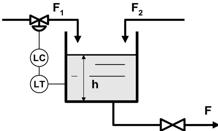
**PROCESO:** tanque de sección circular A y que descarga a través de una válvula con un régimen turbulento.
